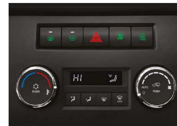
Система отопления, вентиляции и кондиционирования с функцией климат-контроля
