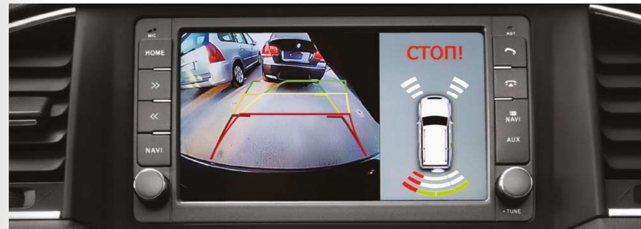
При движении задним ходом на цветной экран выводится изображение с камеры заднего вида с динамическими линиями и работа задних и передних датчиков парковки
