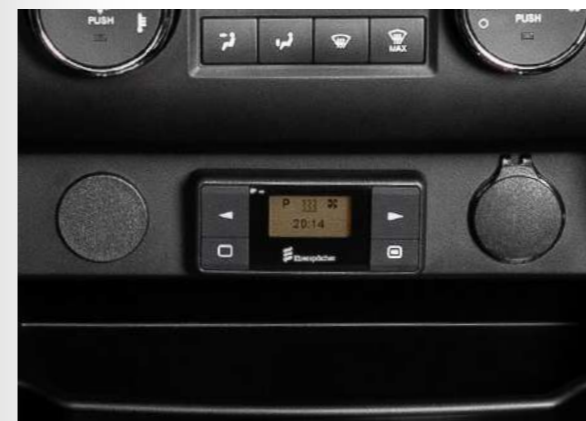
Предпусковой подогреватель с возможностью программирования
