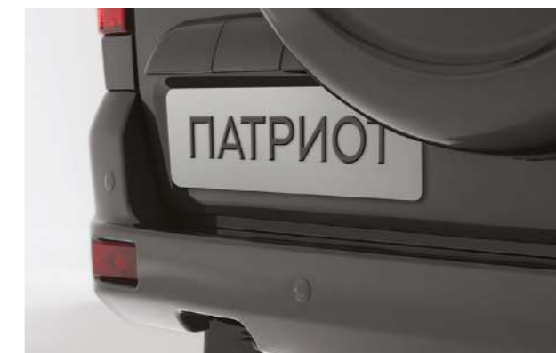
Задние датчики парковки на бампере и камера заднего вида в ручке задней двери
