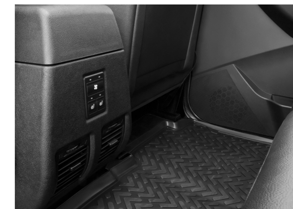
Дополнительный отопитель салона для пассажиров второго ряда
